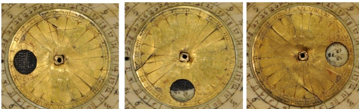
Fig. 6 : Cinq différentes positions de la plaque métallique de la volvelle illustrant différents âges de la Lune (de gauche à droite : nouvelle Lune, premier quartier, pleine Lune, Lune gibbeuse descendante, dernier quartier).
